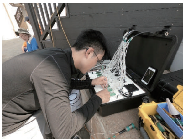
| R2MS 儀器架設
